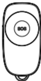
PB206 紧急按钮用于发送紧急消息，只需按下控制器上的按钮即可向移动应用发出警报。
